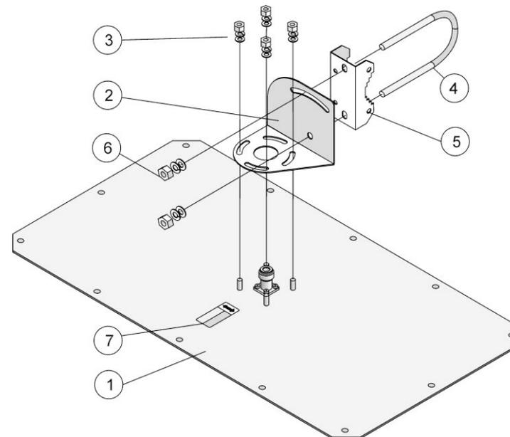
Рисунок 2. Сборка антенны
