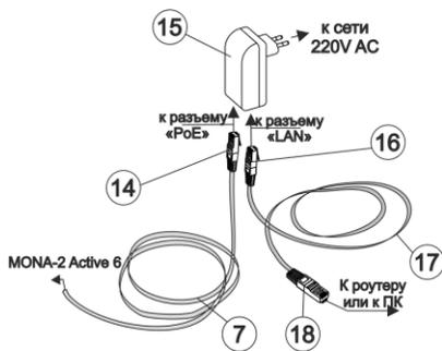
Рисунок 4 - Схема подключения
