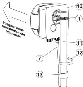
Рисунок 3 - Установка роутера на мачту. Настройка
