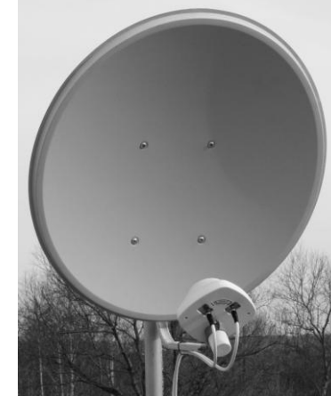
Рисунок 3. Установленный на «тарелку» облучатель с подключенными к нему соединительными кабелями.
