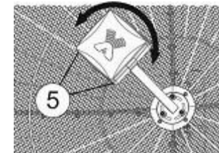
Рисунок 4 – Начальное положение облучателя с поляризацией V+H (слева, при этом более короткий кабель облучателя соответствует вертикальной поляризации, а более длинный - горизонтальной) и X-pol (справа)
